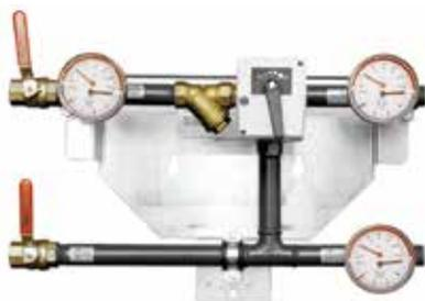
Узел регулирования с трехходовым клапаном предназначен для управления воздухоохладителем вентиляционных установок и кондиционеров при необходимости обеспечения постоянного расхода холодоносителя в трубопроводной сети.
