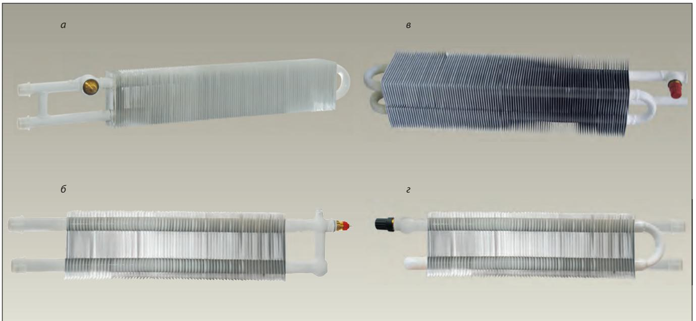
**Рис. 5.** Нагревательный элемент конвектора. а — малой глубины с клапаном типа КТК-П; б — малой глубины с клапаном типа КТК-У; в — средней глубины с клапаном типа КТК-П; г — средней глубины с клапаном типа КТК-У.
