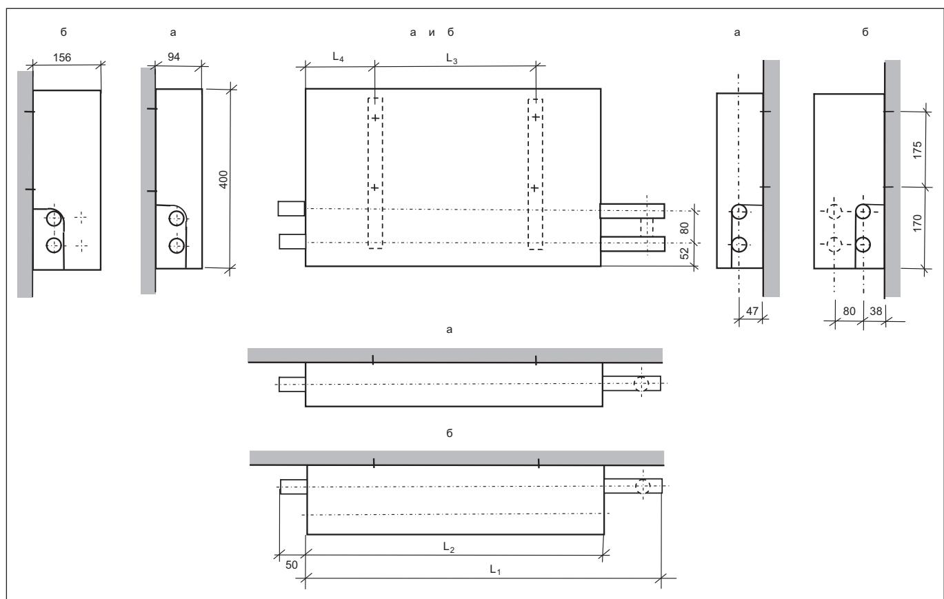
**Рис. 1.8.** Конвектор проходной, малой (а) и средней (б) глубины без клапана терморегулятора правого исполнения (левое исполнение — зеркальное), без байпаса — для конвекторного блока в двухтрубной системе отопления (с байпасом — для конвекторного блока в однотрубной системе).
