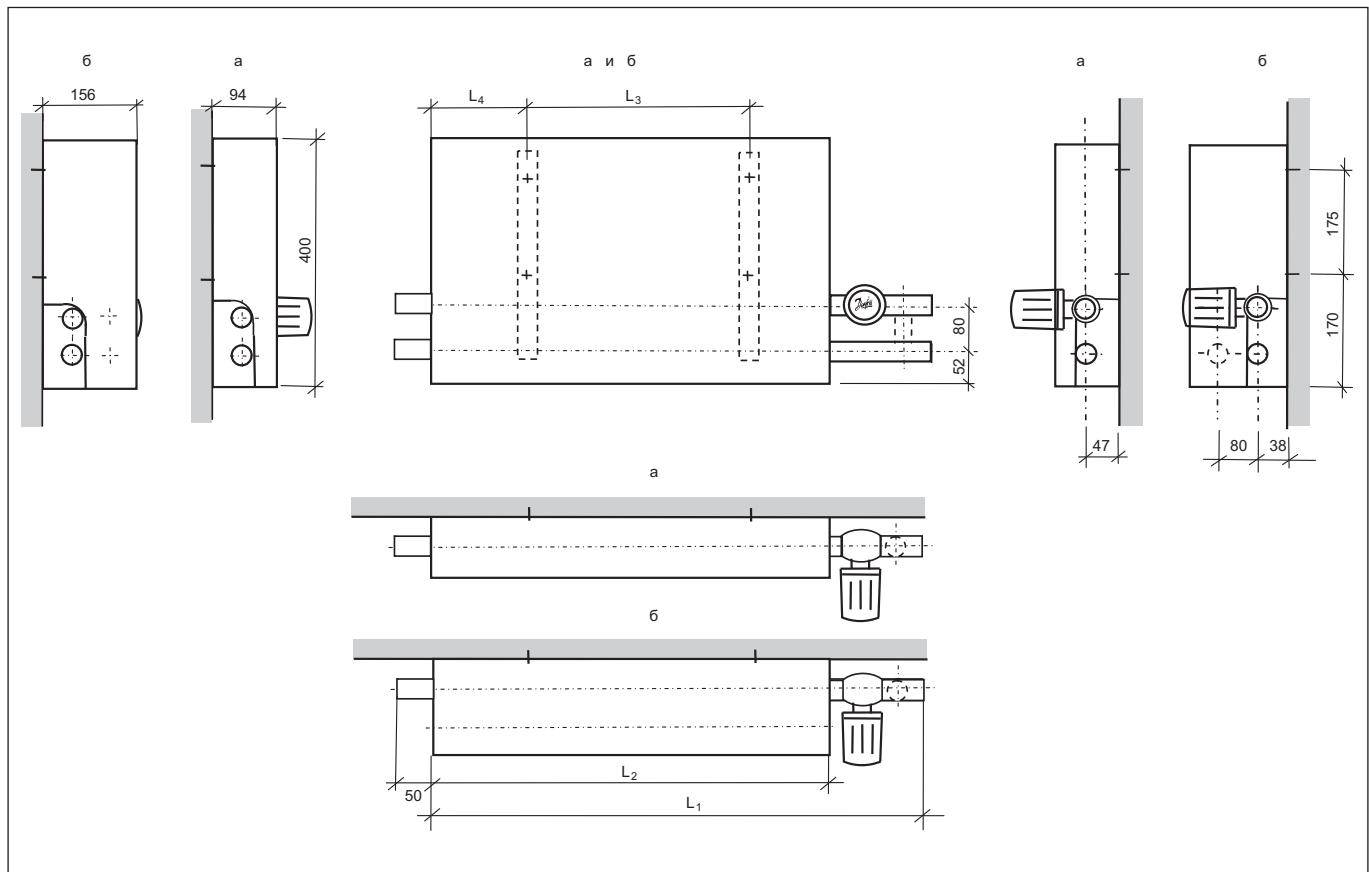
**Рис. 1.3.** Конвектор проходной, малой (а) и средней (б) глубины с клапаном терморегулятора КТК-П1.1 и байпасом или клапаном КТК-П2.1 без байпаса для конвекторного блока в однотрубной или двухтрубной системе отопления (в сочетании с концевым конвектором без терморегулятора) правого исполнения (левое исполнение — зеркальное) при схеме движения теплоносителя «сверху-сниз».
