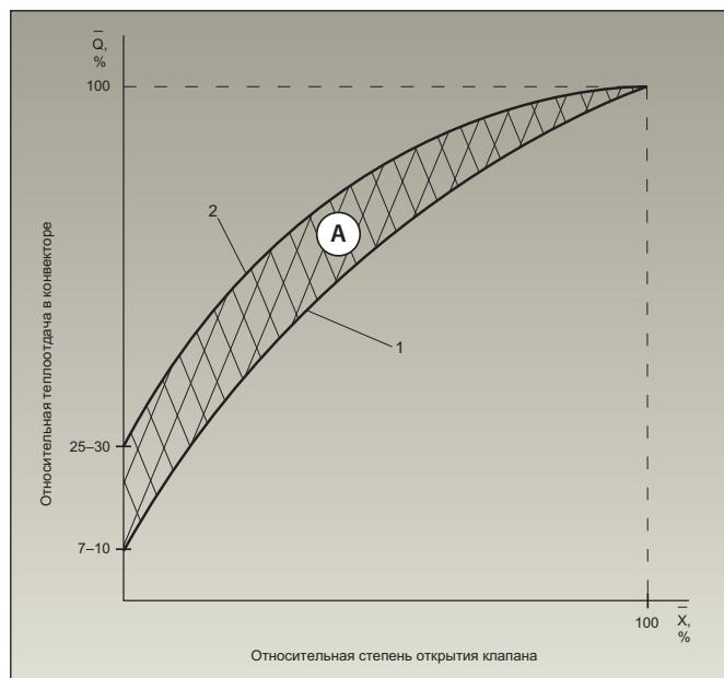
**Рис. 13.** Эффективность регулирования конвектора.
