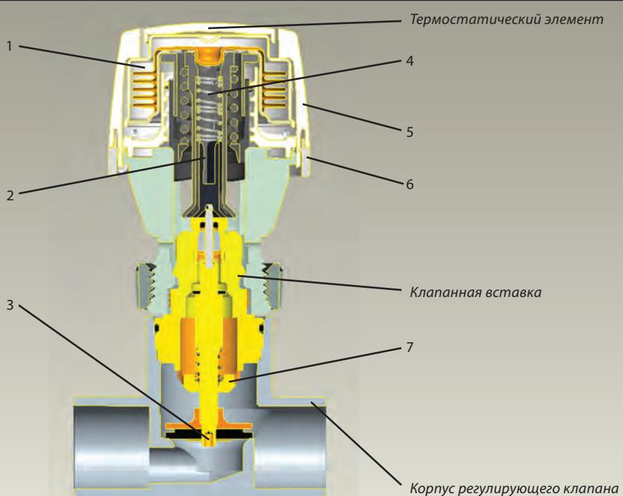
**Рис. 2.** Автоматический радиаторный терморегулятор (для двухтрубной системы отопления). 1 — сильфон; 2 — шток; 3 — золотник; 4 — рабочая пружина; 5 — настроечная рукоятка; 6 — шкала настройки; 7 — дросселирующий цилиндр.
