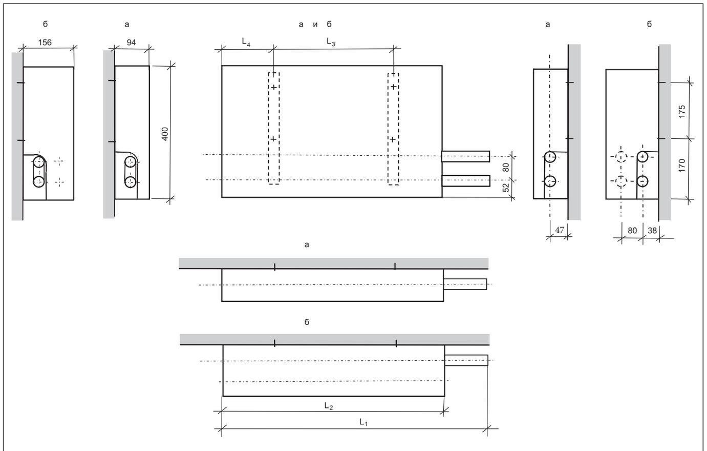
**Рис. 1.7.** Конвектор концевой, малой (а) и средней (б) глубины без клапана терморегулятора для конвекторного блока (в сочетании с проходным конвектором, оснащенным клапаном терморегулятора типа КТК-П) правого исполнения (левое исполнение — зеркальное).
