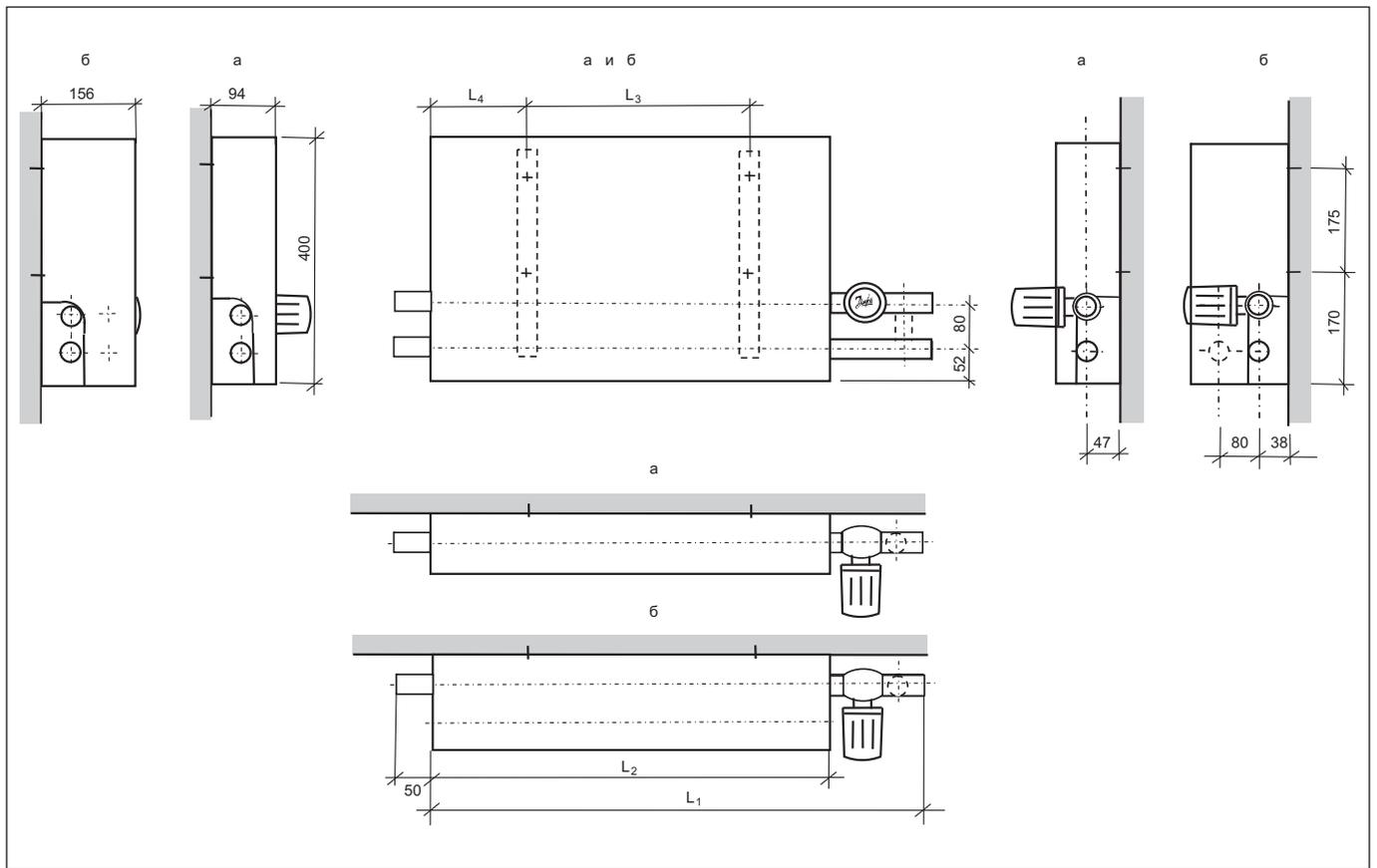
**Рис. 1.3.** Конвектор проходной, малой (а) и средней (б) глубины с клапаном терморегулятора КТК-П1.1 и байпасом или клапаном КТК-П2.1 без байпаса для конвекторного блока в однотрубной или двухтрубной системе отопления (в сочетании с концевым конвектором без терморегулятора) правого исполнения (левое исполнение — зеркальное) при схеме движения теплоносителя «сверху-снизу».
