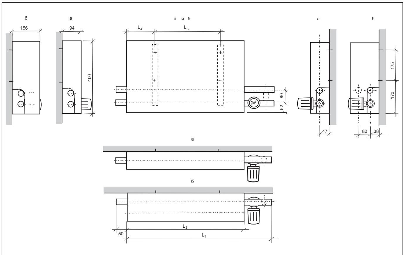
**Рис. 1.4.** Конвектор проходной, малой (а) и средней (б) глубины с клапаном терморегулятора КТК-П1.1 и байпасом для конвекторного блока в однотрубной системе отопления (в сочетании с концевым конвектором без терморегулятора) правого исполнения (левое исполнение — зеркальное) при схеме движения теплоносителя «снизу-вверх».
