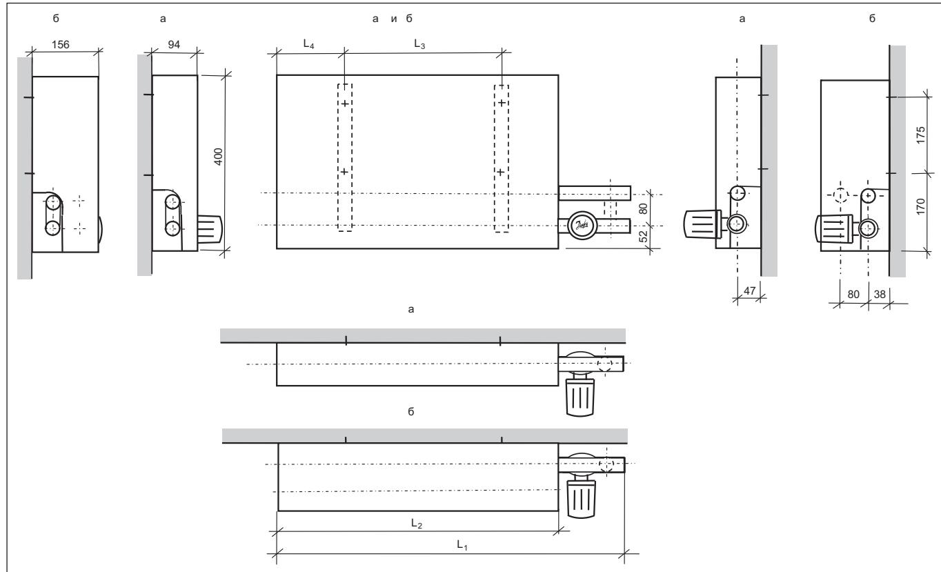
**Рис. 1.2.** Конвектор концевой, малой (а) и средней (б) глубины с клапаном терморегулятора КТК-П1.1 и байпасом (для одиночной установки в однотрубной системе отопления), правого исполнения (левое исполнение — зеркальное) при схеме движения теплоносителя «снизу-вверх».
