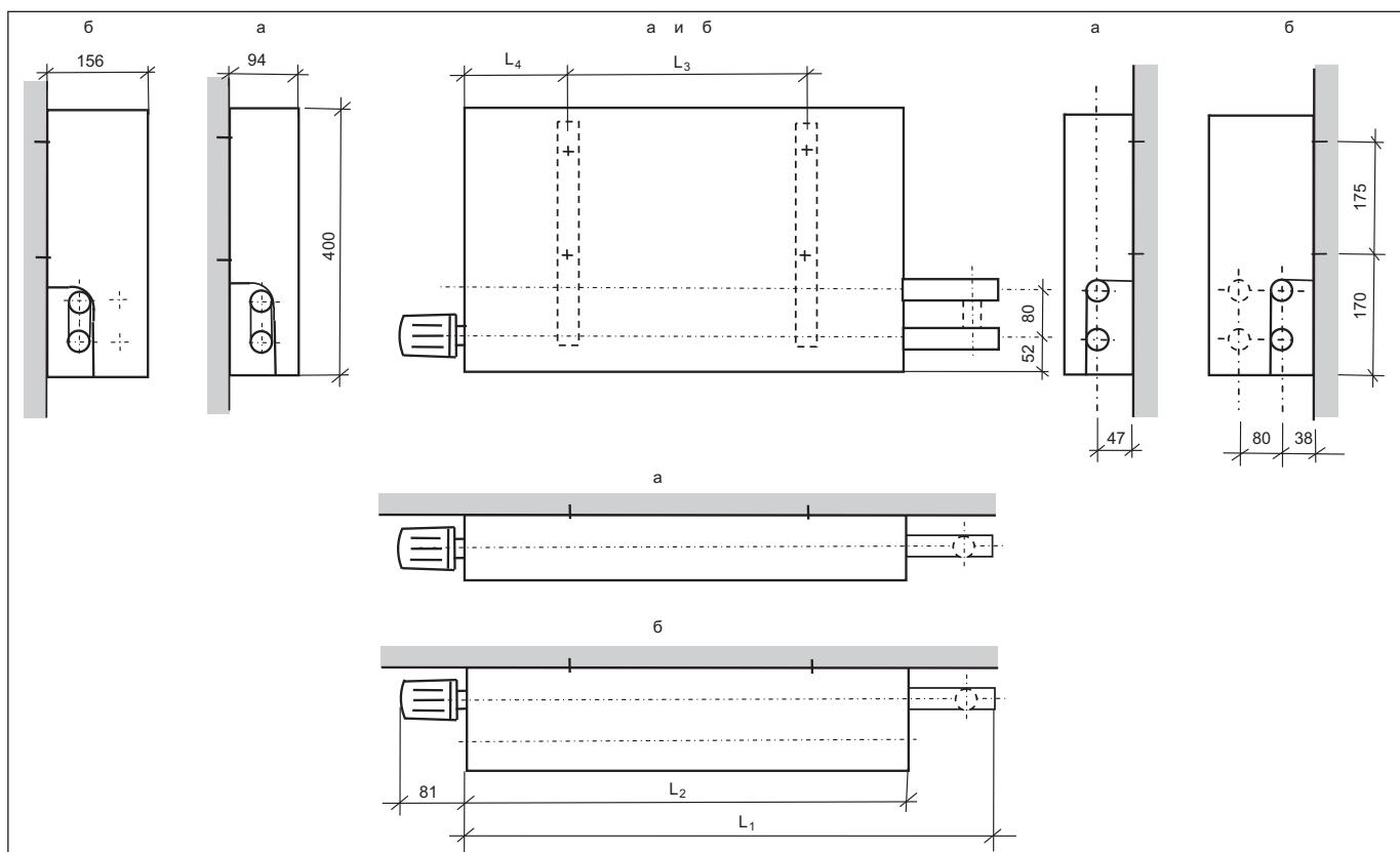
**Рис. 1.6.** Конвектор концевой, малой (а) и средней (б) глубины с клапаном терморегулятора КТК-У-1 правого исполнения (левое исполнение — зеркальное) при схеме движения теплоносителя «снизу-вверх», с байпасом (без байпаса только для комплектации конвекторного блока).
