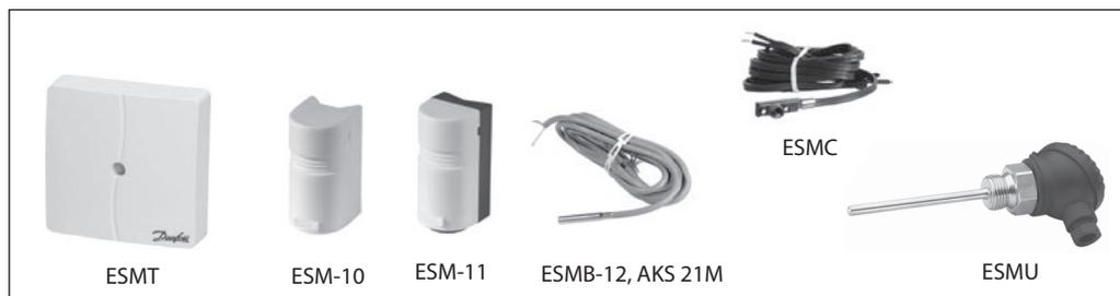
Датчики представляют собой платиновые термометры сопротивления, 1000 Ом при 0 °С. Все температурные датчики являются двухпроводными устройствами с симметричной схемой включения.
