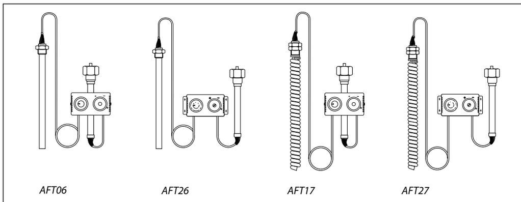
Термостатические элементы серии AFT являются составной частью регуляторов температуры прямого действия и работают по принципу расширения жидкости. Конструкцией термоэлементов AFT06, AFT17 предусматривается встроенный настроечный узел в соединительный элемент, в то время как AFT26, AFT27 поставляются с дистанционным настроечным узлом. Имеются две модификации датчика температуры с различными постоянными времени.
