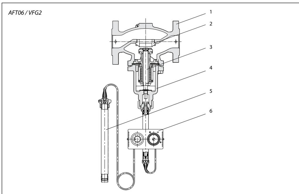
**Комбинации клапанов и термоэлементов**
