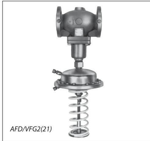
Регулятор AFD/VFG2 (21), AFD/VFGS2 является автоматическим редукционным клапаном для применения в системах централизованного теплоснабжения. При повышении давления после регулятора (по ходу движения теплоносителя) клапан закрывается. Регулятор состоит из фланцевого клапана, регулирующего блока с диафрагмой и пружиной для настройки давления.
