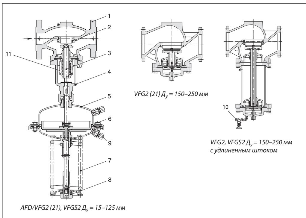
Если система находится в нерабочем состоянии, то клапан полностью открыт. Давление в системе после регулирующего клапана передается в полость под регулируемую диафрагму (со стороны настроечной пружины) через импульсную трубку. На другую сторону диафрагмы действует атмосферное давление.
