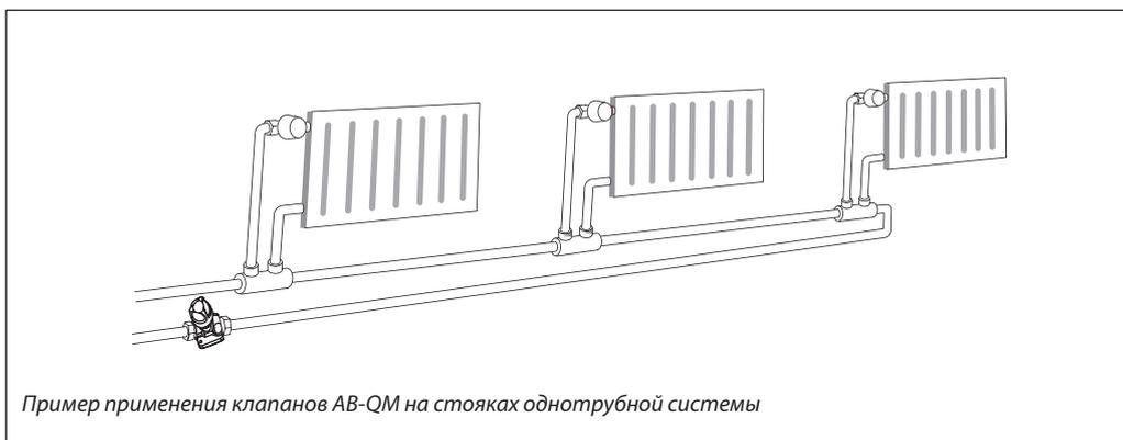
Пример применения клапанов АВ-QM на стояках однотрубной системы
