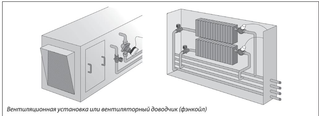
Вентиляционная установка или вентиляторный доводчик (фэнкойл)
